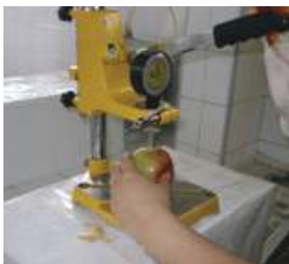
Figura 4 - Penetrómetro utilizado para medir a firmeza da polpa das frutas. Foto: José Carlos Fachinello
