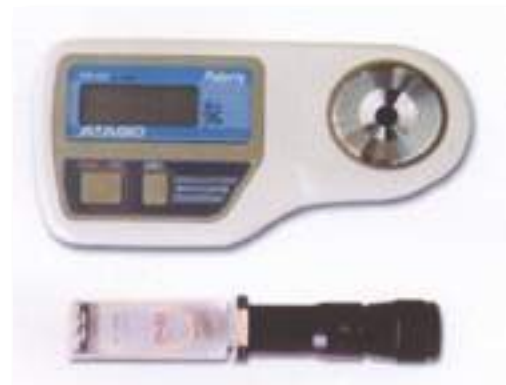
Figura 5 - Refratômetros utilizados para a determinação do teor de sólidos solúveis totais (SST) das frutas. Foto: José Carlos Fachinello
