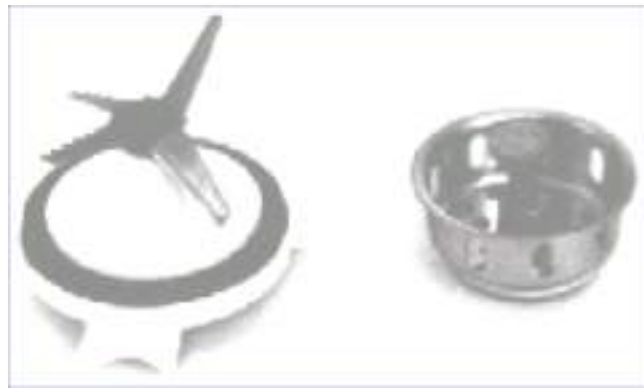
Figura 34 - Adaptação da peça central de um liquidificador comum, em que a hélice é substituída e soldada a um ralo de lava-louças inox.
